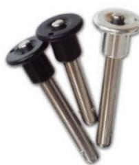
Der Finsterwalder KUGELSPERRBOLZEN/ QUICKPIN ist ein selbstsichernder Bolzen mit Knopfdruck-Entriegelung für zahlreiche Anwendungen, besonders im Flugsport-Bereich und in der Rehathechnik. Schaft, Achse und Sperrkugeln dieses seit 1975 bewährten Finsterwalder Qualitätsprodukts bestehen aus hochfestem Edelstahl. Drei Sperrkugeln anstelle der sonst üblichen zwei bewirken doppelte Anzugsfestigkeit.
