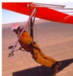
Funfex: Kennzeichen sind die schlaff hängenden Flügel. Doch diese negative V-Form bewirkt eine kurze Rollzeit. Links unten: Selbstverriegelnde Schnellverschlüsse erleichtern den Aufbau. Rechts: Das Trapez ist ungewöhnlich weit hinter der Pilotenaufhängung - dadurch wird die Landung erleichtert.
