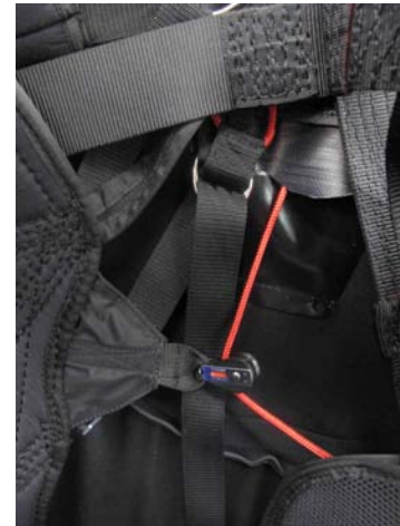
Beschleunigerseil-Verlauf an den oberen Rolle
