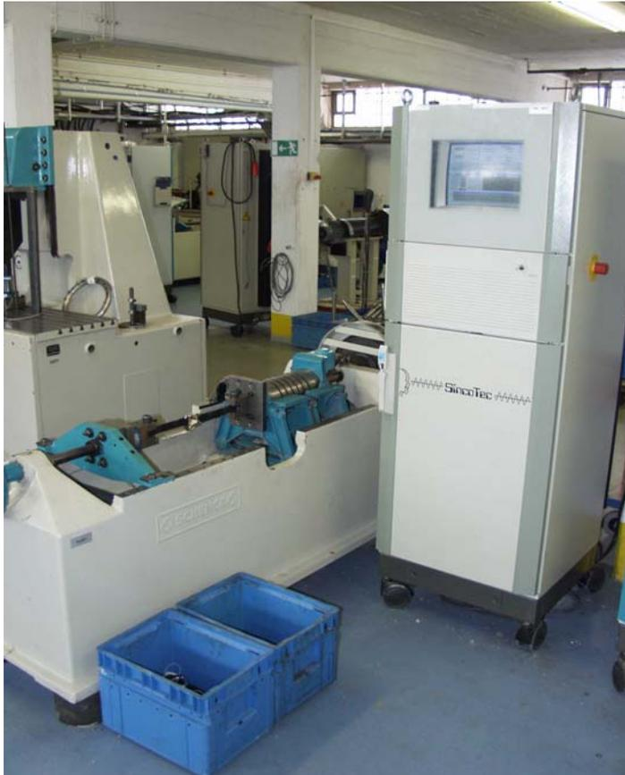
Bild 1: Foto des Resonanzprüfstandes
