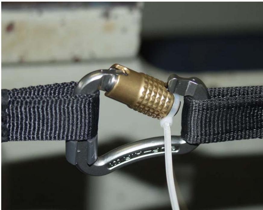
Bild 3: Foto der Einspannvorrichtung mit größtmöglichem Hebelarm
