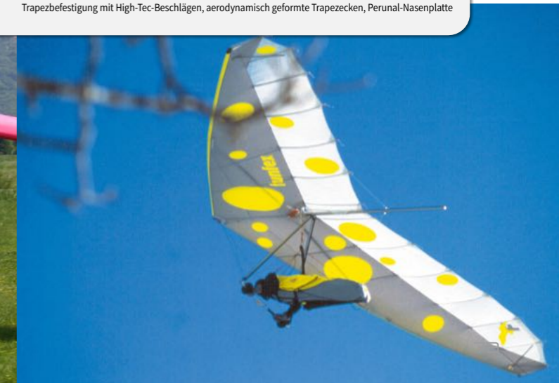
Trapezbefestigung mit High-Tec-Beschlägen, aerodynamisch geformte Trapezdecken, Perunal-Nasenplatte
